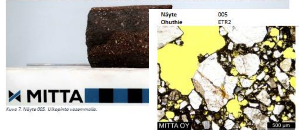
Kuva 8. Pystysaumassa kiviainestartunnoissa on paikoin huokasia. PPL
